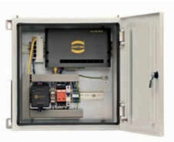
Abb. 3: RFID-Empfangseinheit, die ganz speziell für die raue Bahnumwelt ausgelegt ist
